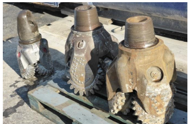
Figure 9. Tréfans tricônes de différents diamètres utilisés pour les forages Rotary (photo F. Audubert).
